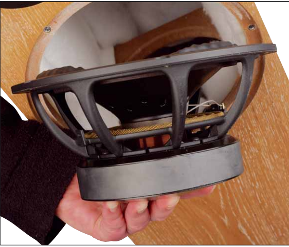
Der Tieftöner verfügt über einen ziemlich imposanten Antrieb
